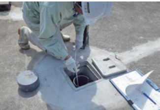
地下水位測定
