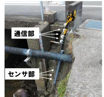
写真1 寺込川河口への設置状況
