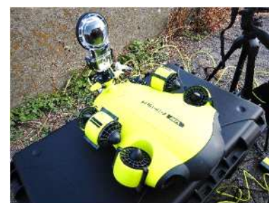
写真-3 VRカメラを搭載した水中ドローン
